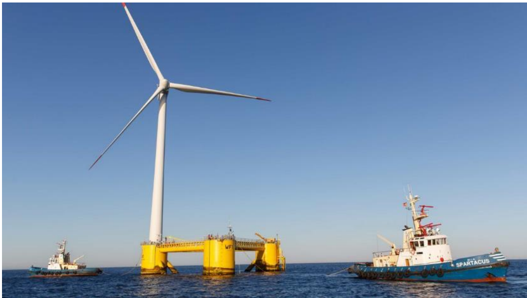
Figura 27: Transporte de un aerogenerador marino para el proyecto de WindFloat Atlantic (Fuente: EDPr).
