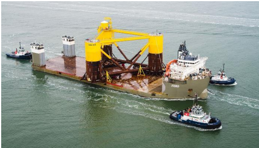
Figura 7: Estructura semi-sumergible transportada hasta el parque eólico marino de Kincardine (Fuente: Navantia).
