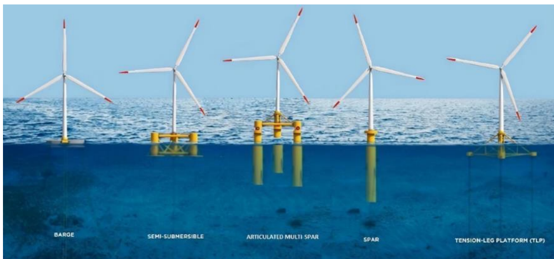
Figura 6: Tecnologías de plataformas de eólica marina flotante (Fuente: WindPower, 2019).
